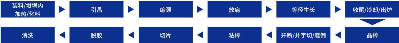
单晶硅片制作工艺流程图
